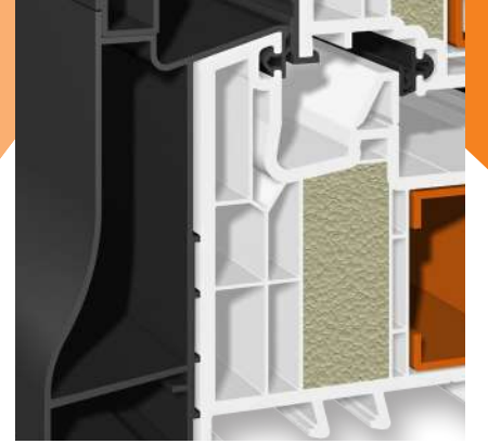
uPVC ve alüminyum arasında oluşturulan hava boşluğu ile geliştirilmiş yalıtım.
